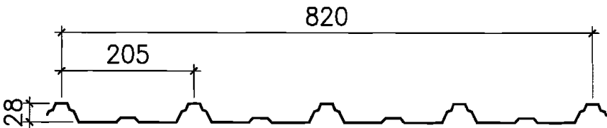
压型钢板允许檩距 (YX28-205-820 适用于墙板)
