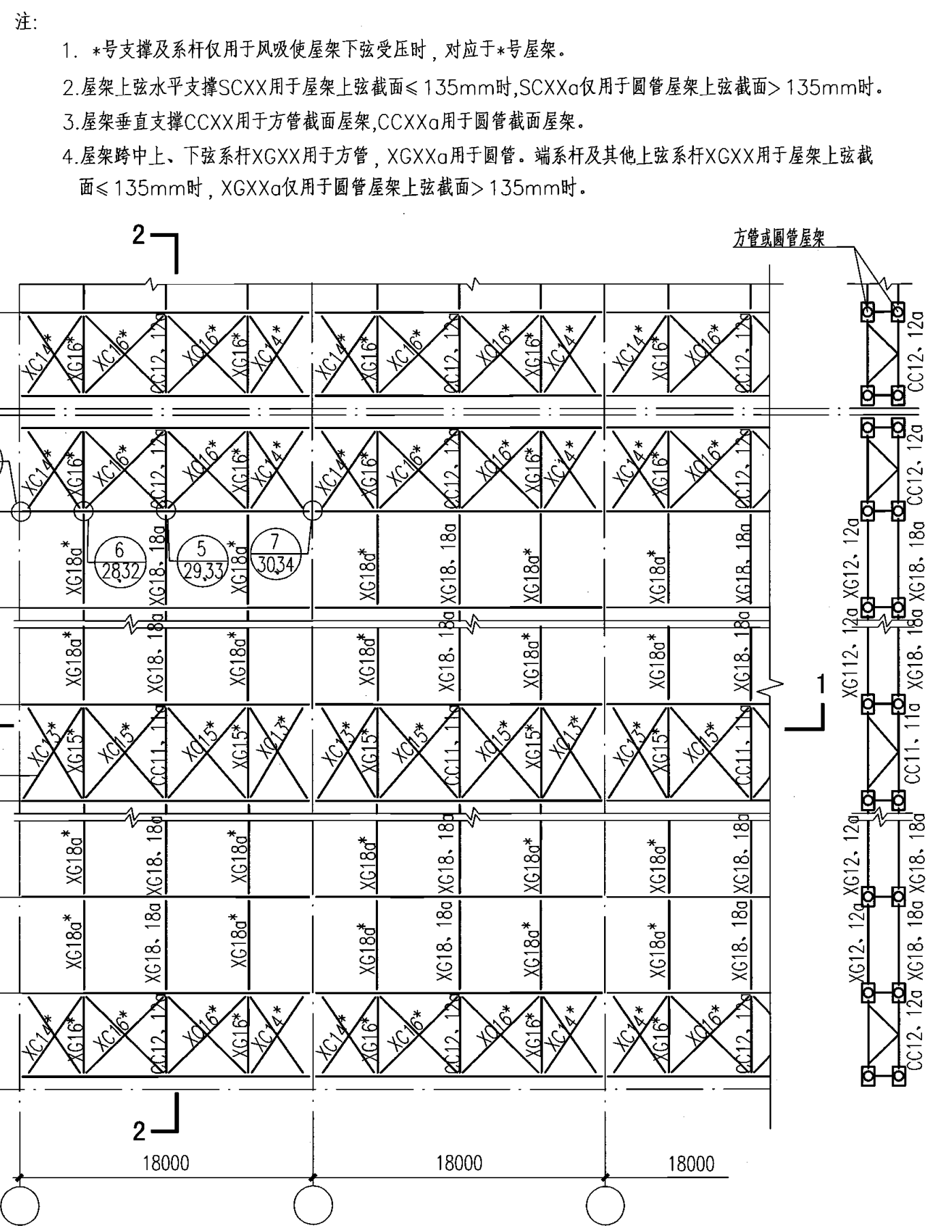
屋架下弦、竖向支撑构件编号图 用于非抗震及6、7、8度
