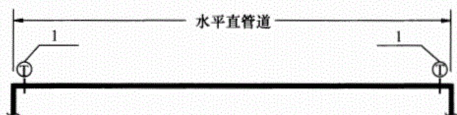
图 19 水平直管段抗震支吊架设置
